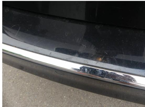
Bild 4: Karosserie / Stoßfänger hinten zerkratzt
