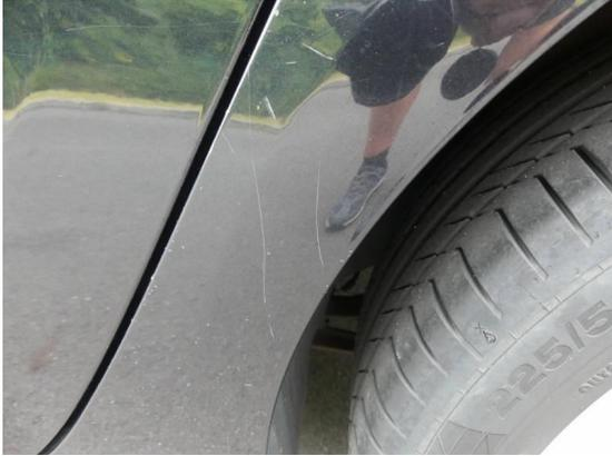
Bild 43: Karosserie / Seitenteil links leicht deformiert und zerkratzt
