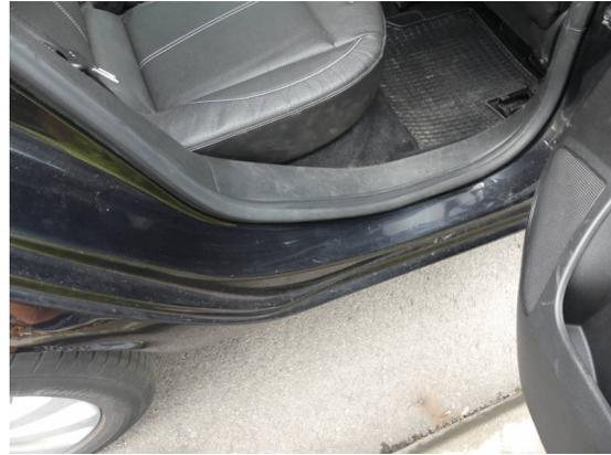
Bild 14: Karosserie / Einstieg hinten rechts Delle und zerkratzt
