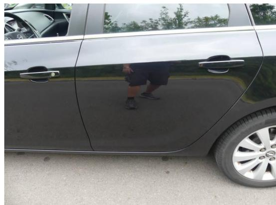
Bild 42: Karosserie / Tür hinten links zerkratzt
