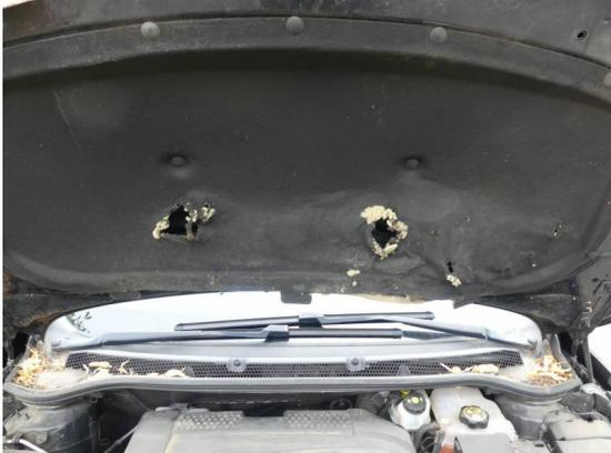
Bild 1: Technik / Dämmmatte Motorhaube eingerissen
