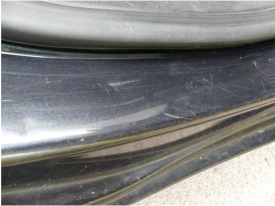
Bild 13: Karosserie / Einstieg hinten rechts Delle und zerkratzt
