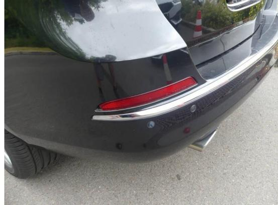
Bild 2: Technik / Rückstrahler im Stoßfänger hinten links gebrochen
