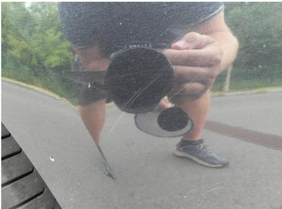
Bild 3: Karosserie / Stoßfänger hinten zerkratzt
