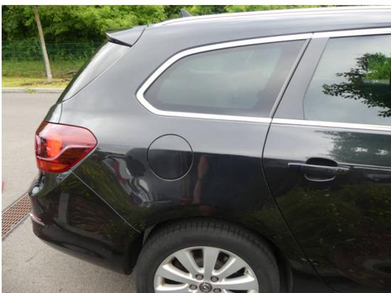
Bild 11: Karosserie / Seitenteil rechts Delle und zerkratzt
