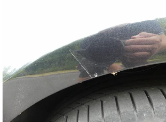
Bild 32: Karosserie / Kotflügel links zerkratzt
