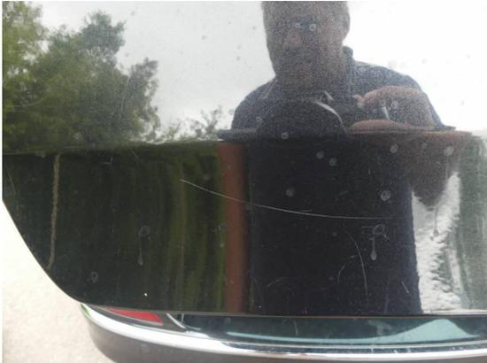
Bild 7: Karosserie / Heckklappe zerkratzt
