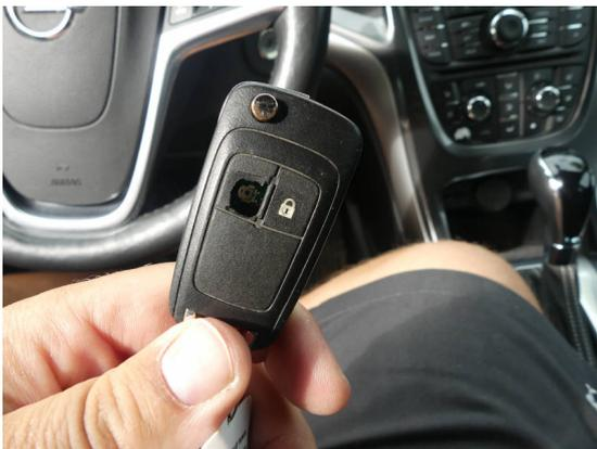
Bild 27: Technik / Schlüsselfernbedienung Gehäuse gebrochen
