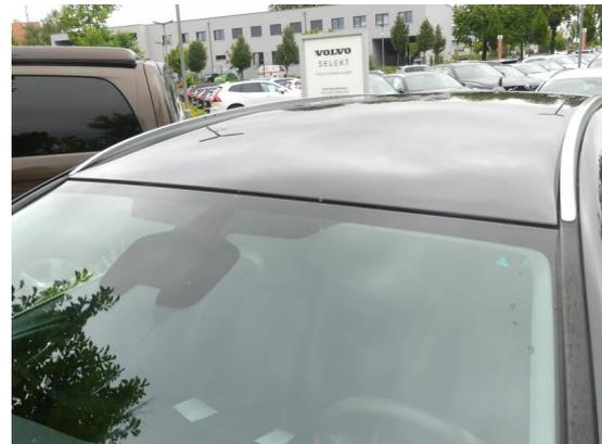
Bild 24: Karosserie / Dachkante vorn Steinschlag mit Korrosionsansatz
