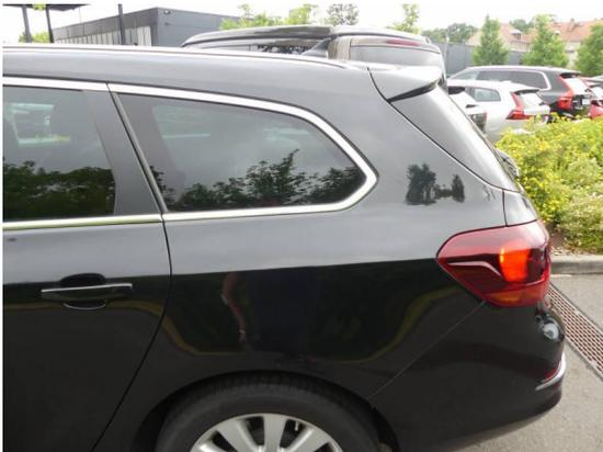
Bild 45: Karosserie / Seitenteil links leicht deformiert und zerkratzt
