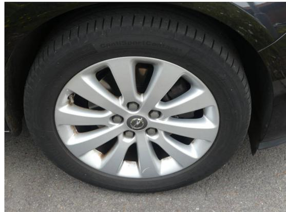
Bild 46: Reifen - Felge / Felge vorne rechts Kratzer
