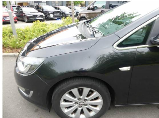
Bild 34: Karosserie / Kotflügel links zerkratzt
