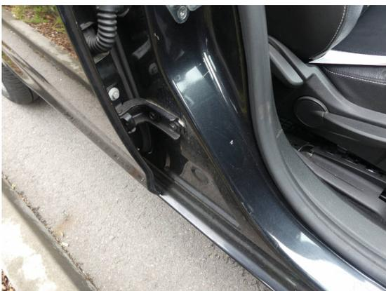
Bild 17: Karosserie / B-Säule rechts Delle und zerkratzt
