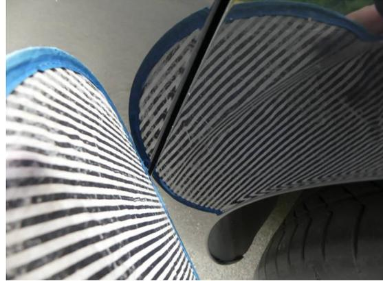
Bild 44: Karosserie / Seitenteil links leicht deformiert und zerkratzt
