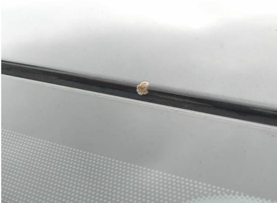
Bild 23: Karosserie / Dachkante vorn Steinschlag mit Korrosionsansatz
