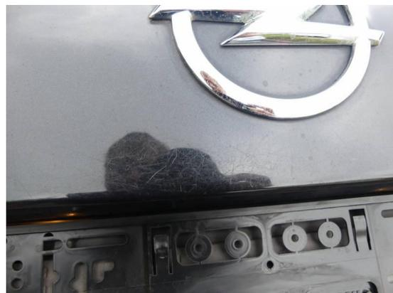
Bild 6: Karosserie / Heckklappe zerkratzt
