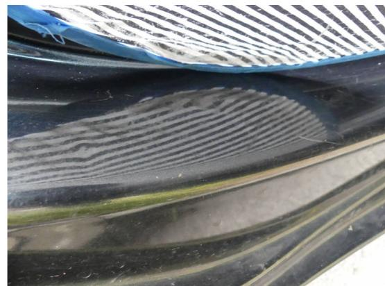
Bild 12: Karosserie / Einstieg hinten rechts Delle und zerkratzt
