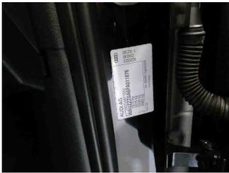
Fahrzeug - Typenschild/Fahrgestellnummer
