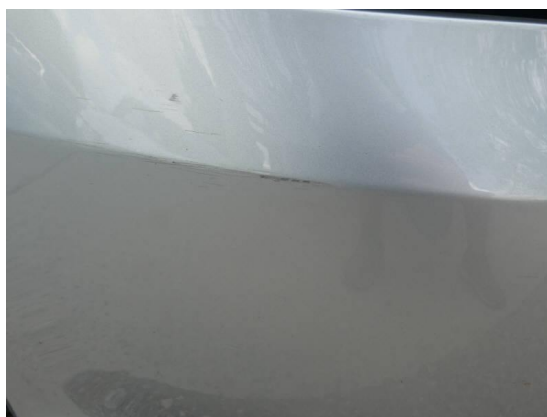
Bild 46: Karosserie / Stoßfänger vorn zerkratzt und gestaucht
