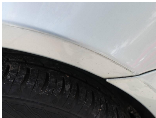
Bild 44: Karosserie / Kotflügel rechts leicht deformiert und zerkratzt
