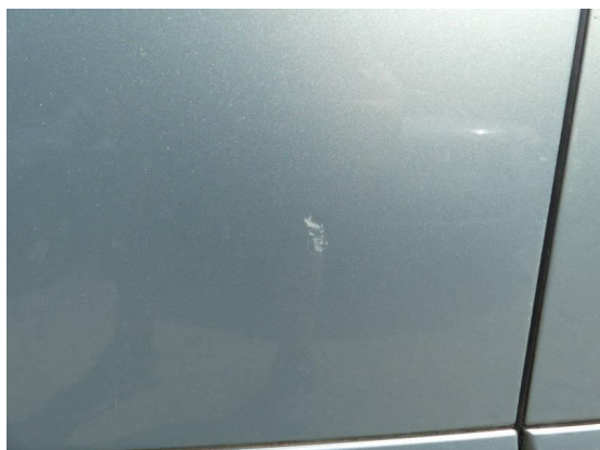
Bild 7: Karosserie / Tür vorne links leicht deformiert und zerkratzt
