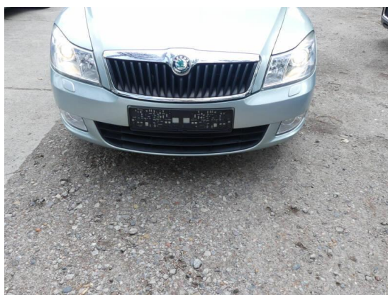
Bild 48: Karosserie / Stoßfänger vorn zerkratzt und gestaucht
