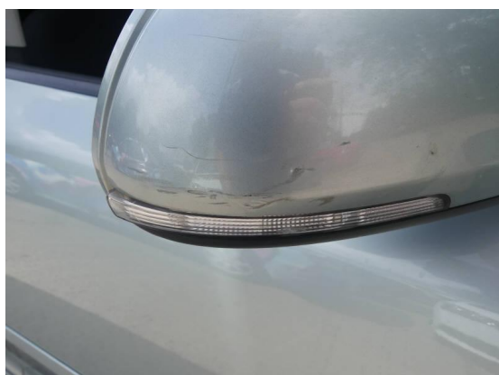
Bild 41: Karosserie / Spiegelkappe rechts Kratzer
