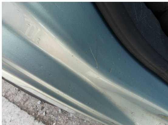
Bild 31: Karosserie / Einstieg hinten rechts zerkratzt
