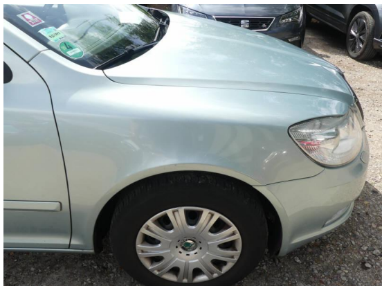
Bild 43: Karosserie / Kotflügel rechts leicht deformiert und zerkratzt
