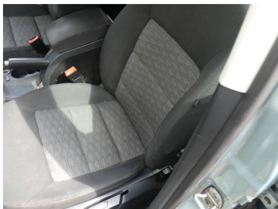
Bild 61: Innenraum / Fahrersitzbezug und Polster verschlissen
