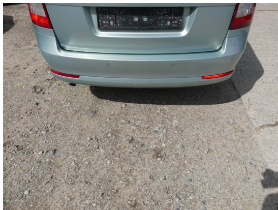
Bild 20: Karosserie / Stoßfänger hinten zerkratzt und Halter abgebrochen
