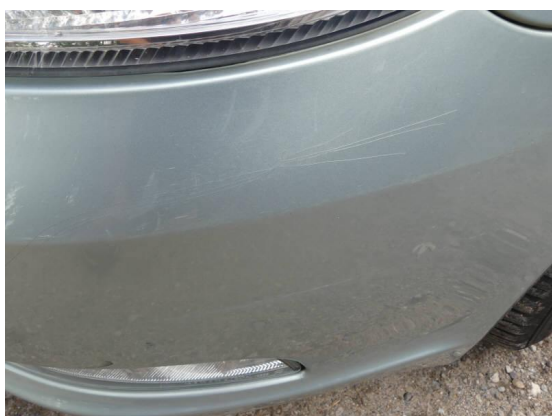
Bild 47: Karosserie / Stoßfänger vorn zerkratzt und gestaucht
