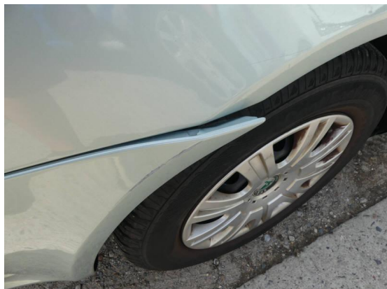
Bild 19: Karosserie / Stoßfänger hinten zerkratzt und Halter abgebrochen
