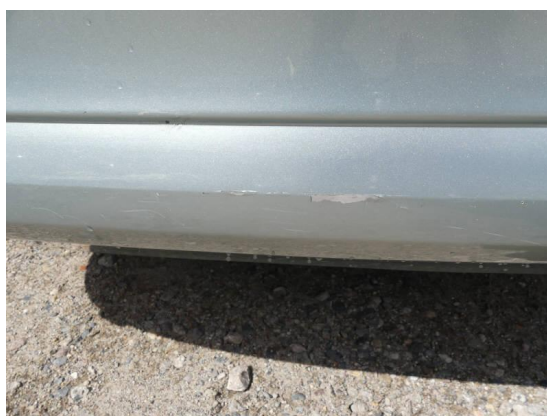
Bild 18: Karosserie / Stoßfänger hinten zerkratzt und Halter abgebrochen
