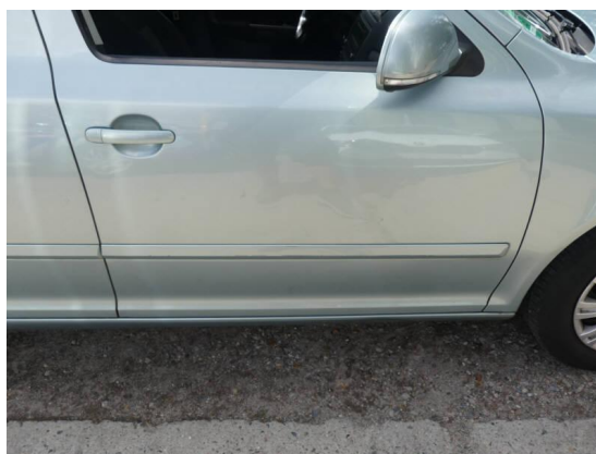
Bild 40: Karosserie / Tür vorne rechts leicht deformiert
