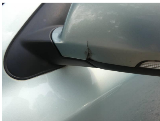
Bild 51: Karosserie / Spiegelkappe links gebrochen
