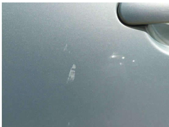
Bild 13: Karosserie / Tür hinten links Dellen und zerkratzt
