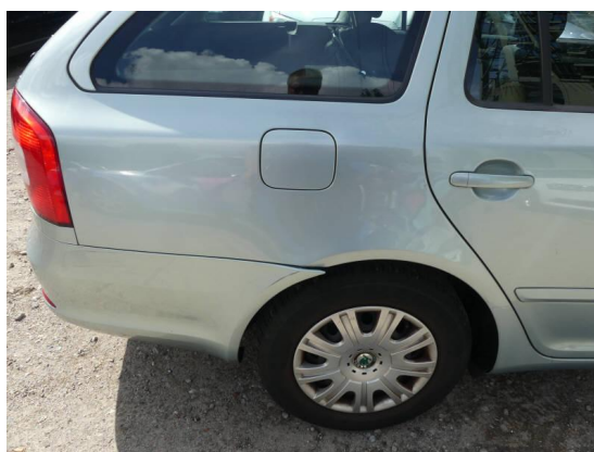
Bild 30: Karosserie / Seitenteil rechts Delle und zerkratzt
