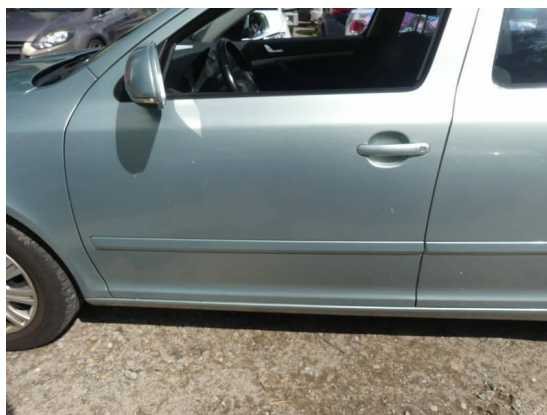
Bild 8: Karosserie / Tür vorne links leicht deformiert und zerkratzt
