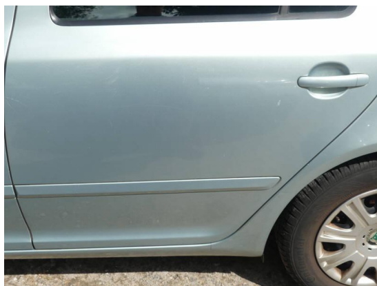
Bild 14: Karosserie / Tür hinten links Dellen und zerkratzt
