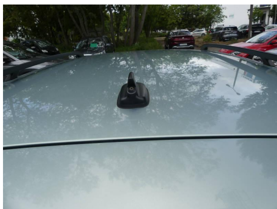
Bild 63: Technik / Antennenstab fehlt
