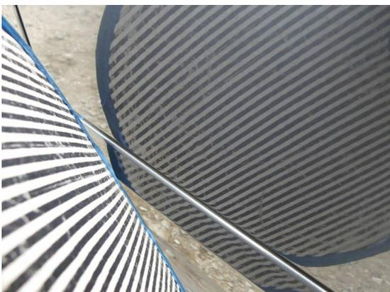
Bild 5: Karosserie / Tür hinten links Delle und zerkratzt
