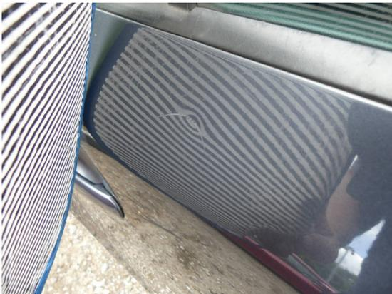
Bild 21: Karosserie / Tür hinten rechts leicht deformiert und zerkratzt
