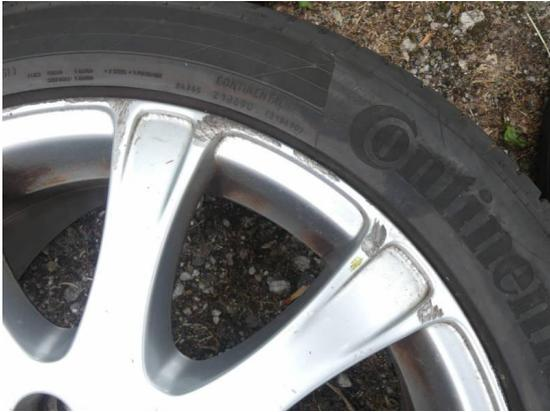
Bild 49: Reifen - Felge / Alufelgen alle zerkratzt
