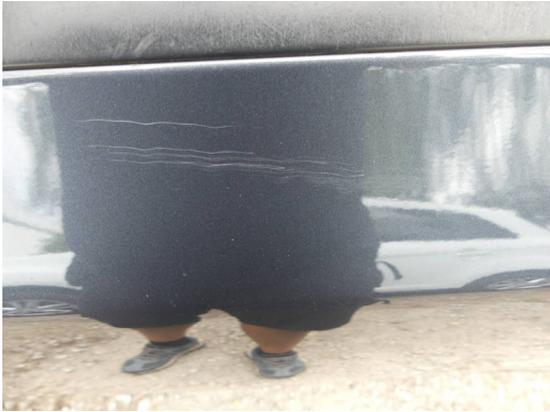
Bild 7: Karosserie / Tür hinten links Delle und zerkratzt
