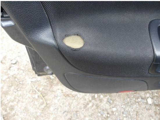
Bild 45: Innenraum / Türverkleidung vorne links Loch im Stoff
