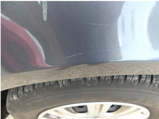
Bild 33: Karosserie / Kotflügel rechts zerkratzt
