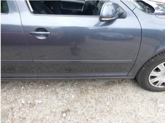
Bild 31: Karosserie / Tür vorne rechts zerkratzt
