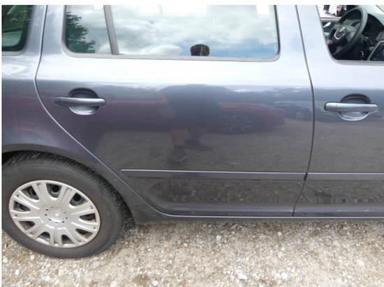
Bild 23: Karosserie / Tür hinten rechts leicht deformiert und zerkratzt
