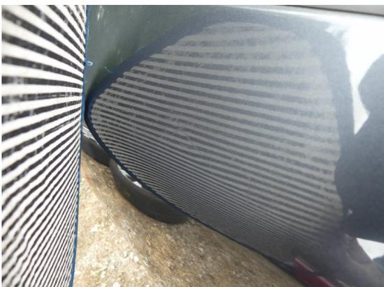
Bild 17: Karosserie / Seitenteil rechts Dellen und zerkratzt
