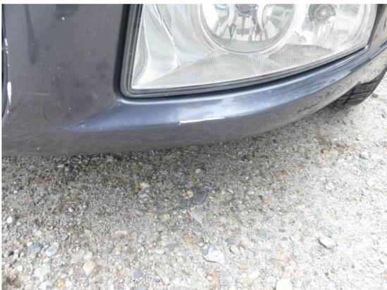
Bild 27: Karosserie / Stoßfänger vorn zerkratzt
