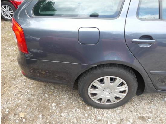
Bild 19: Karosserie / Seitenteil rechts Dellen und zerkratzt
