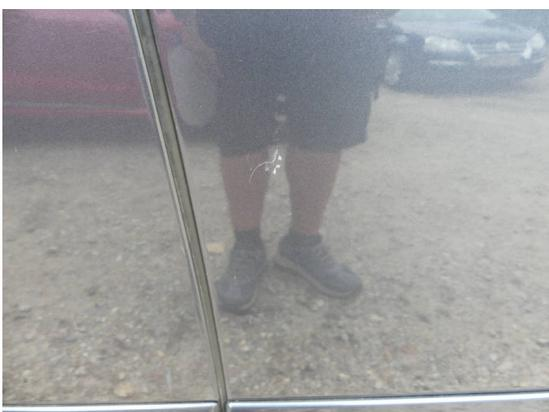
Bild 29: Karosserie / Tür vorne rechts zerkratzt
