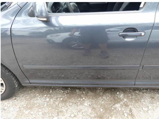
Bild 47: Karosserie / Tür vorne links Delle mit Kratzer
