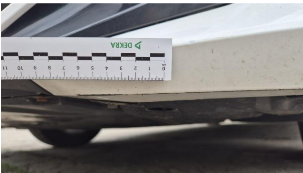
Fot. 40. Zderzak - Rysa/odprysk 1
