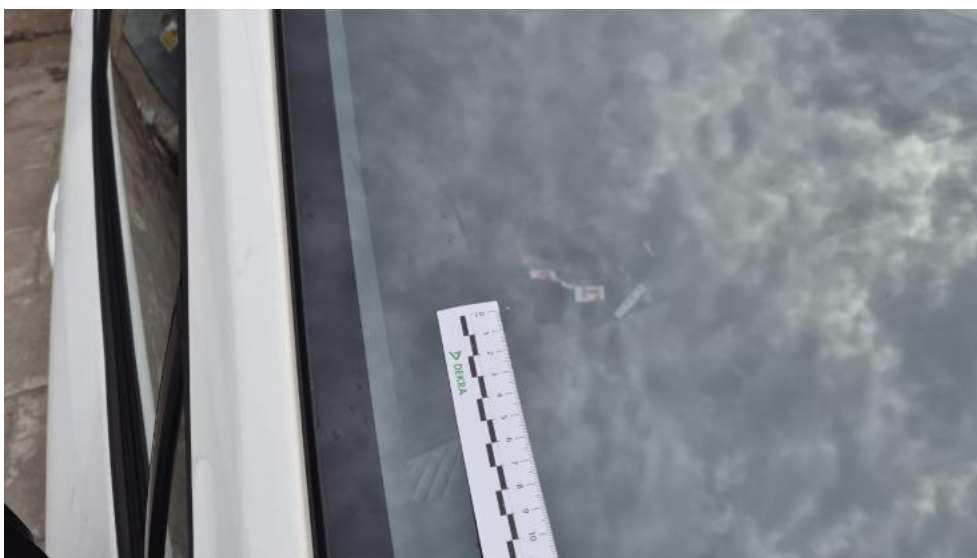
Fot. 38. Szyba czołowa - Rysa/odprysk 1
