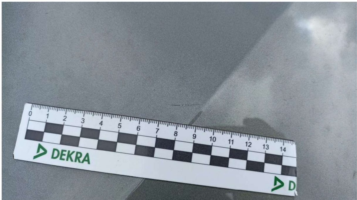
Fot. 34 Pokrywa komory silnika - Rysa/odprysk 1
