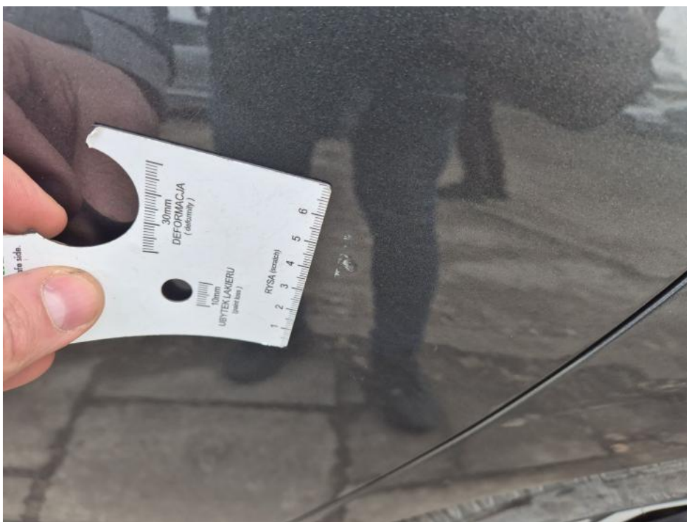
Fot. 43. Drzwi tylne L - Rysa/odprysk 1
