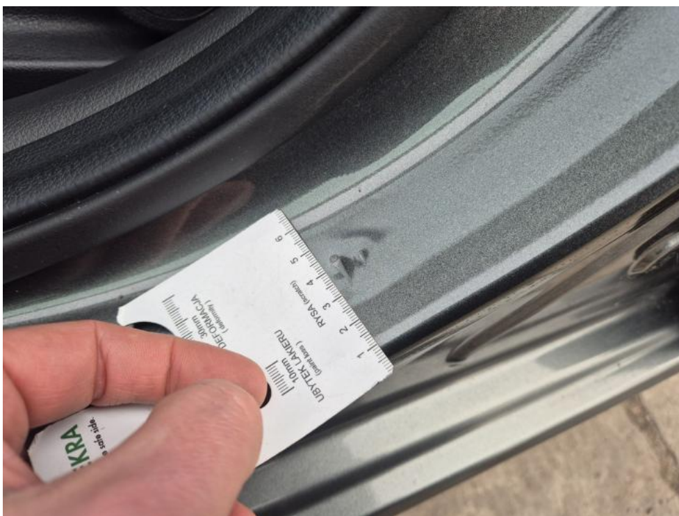
Fot. 44. Próg L - Rysa/odprysk 1
