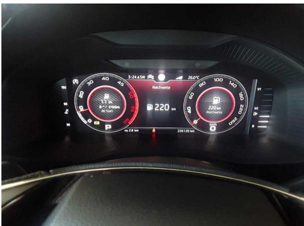
Abbildung 5: Kombiinstrument
