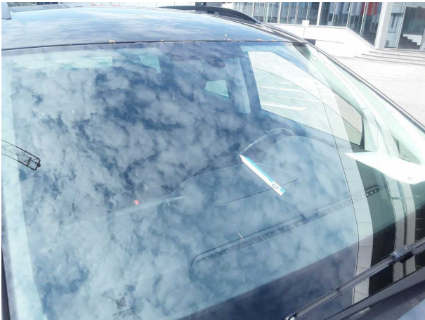
Beschädigung #1: Verglasung: Frontscheibe - Steinschlag - erneuern
