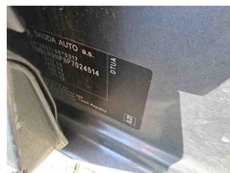
Fahrzeug - Typenschild/Fahrgestellnummer
