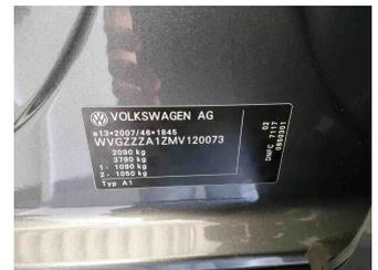
Fahrzeug - Typenschild/Fahrgestellnummer
