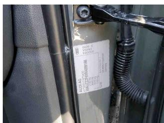
Fahrzeug - Typenschild/Fahrgestellnummer
