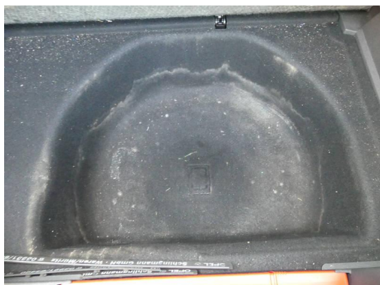
Bild 13: Innenraum / Teppich Kofferraum Schimmelflecken
