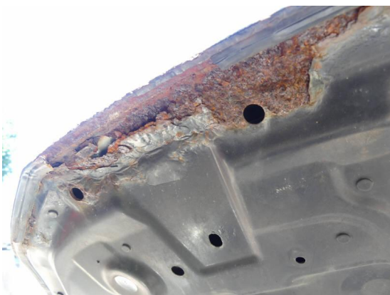
Bild 11: Karosserie / Motorhaube stark korrodiert und zerkratzt
