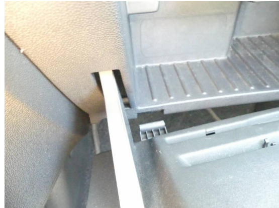
Bild 8: Innenraum / Deckel Handschuhfach gebrochen
