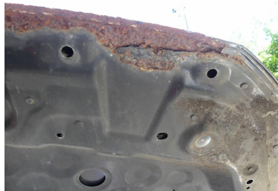
Bild 10: Karosserie / Motorhaube stark korrodiert und zerkratzt
