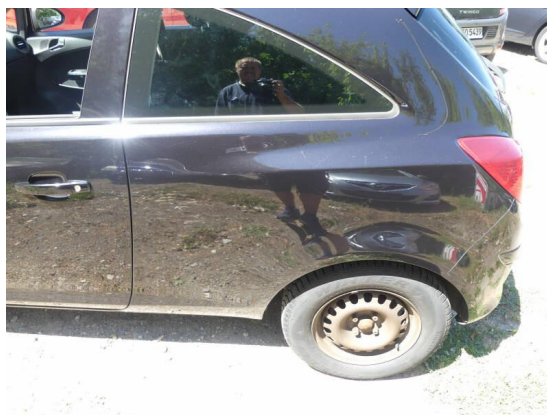
Bild 20: Karosserie / Seitenteil links Vorschaden bricht auf
