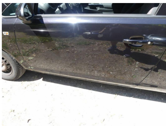
Bild 18: Karosserie / Tür links Delle und Kratzer
