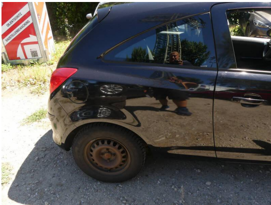
Bild 27: Karosserie / Seitenteil rechts Kratzer und Korrosion unter Lack
