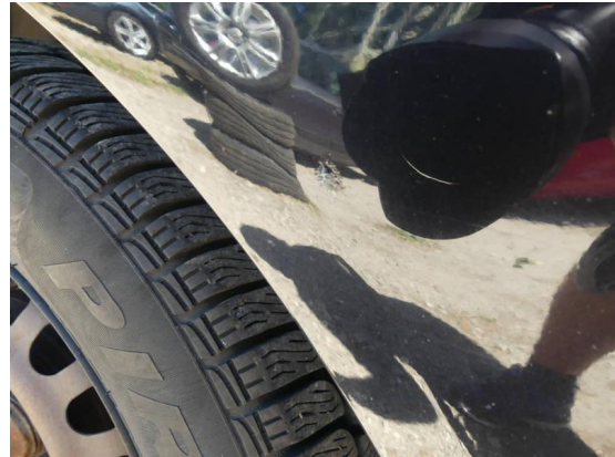
Bild 26: Karosserie / Seitenteil rechts Kratzer und Korrosion unter Lack
