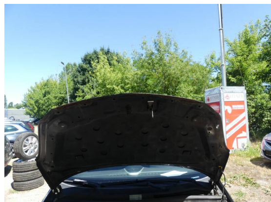
Bild 12: Karosserie / Motorhaube stark korrodiert und zerkratzt
