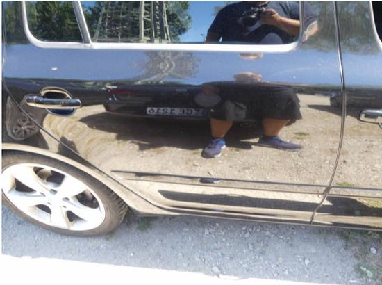
Bild 19: Karosserie / Tür hinten rechts Delle und zerkratzt
