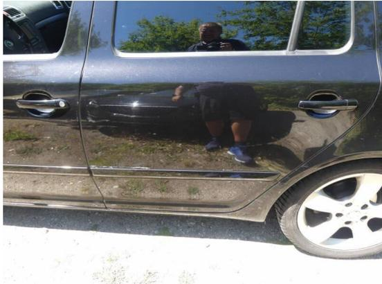
Bild 7: Karosserie / Tür hinten links zerkratzt
