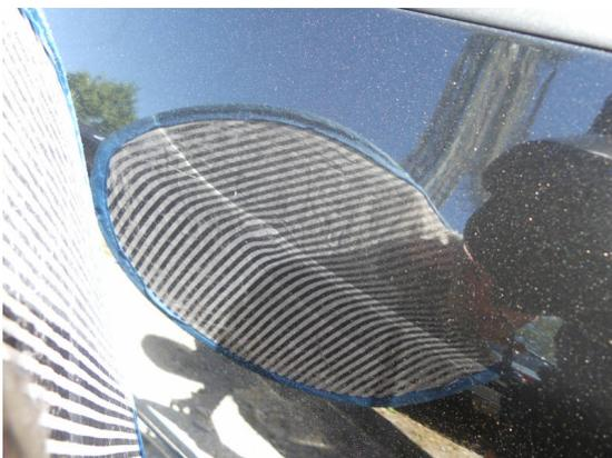
Bild 17: Karosserie / Tür hinten rechts Delle und zerkratzt
