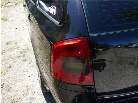
Bild 13: Technik / Rückleuchte rechts und links gebrochen
