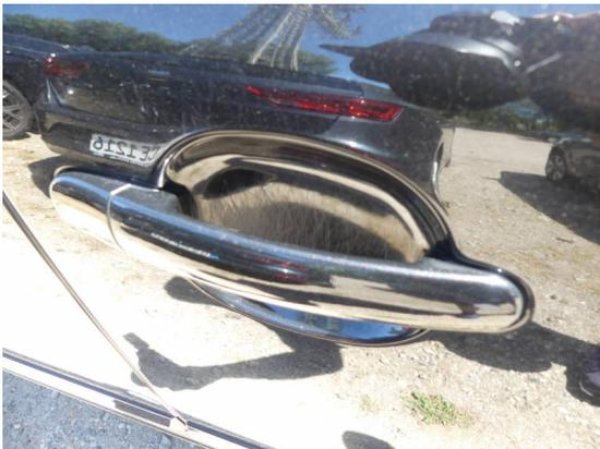
Bild 21: Karosserie / Tür vorne rechts Dellen und zerkratzt
