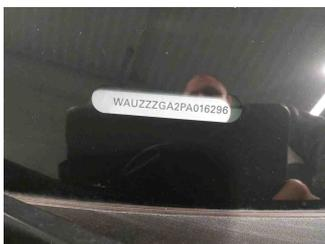
Fahrzeug - Typenschild/Fahrgestellnummer
