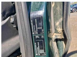
Fahrzeug - Typenschild/Fahrgestellnummer
