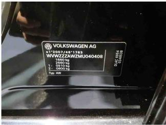
Fahrzeug - Typenschild/Fahrgestellnummer
