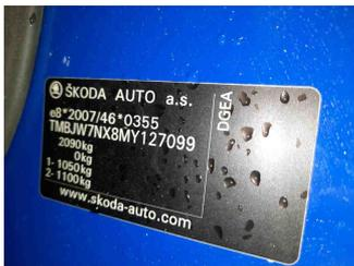
Fahrzeug - Typenschild/Fahrgestellnummer
