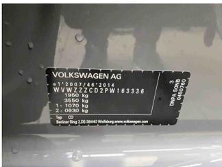
Fahrzeug - Typenschild/Fahrgestellnummer
