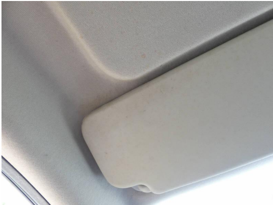
Bild 25: Innenraum / Himmel vergilbt und fleckig
