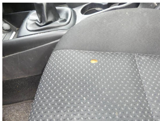
Bild 40: Innenraum / Fahrersitz Bezug verschlissen und Brandloch
