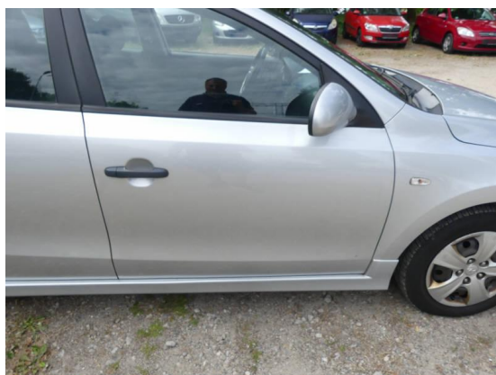
Bild 21: Karosserie / Tür vorne rechts leicht deformiert und zerkratzt
