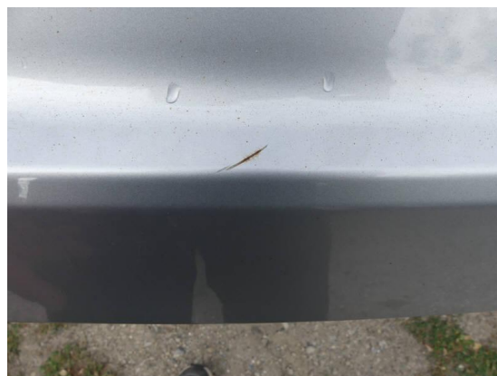
Bild 14: Karosserie / Heckklappe Kratzer mit Korrosion
