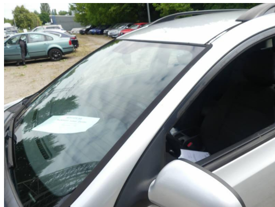
Bild 38: Karosserie / A-Säule links Steinschlag mit Korrosion
