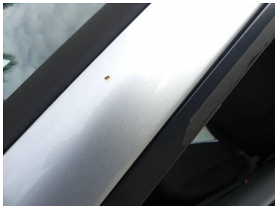
Bild 37: Karosserie / A-Säule links Steinschlag mit Korrosion
