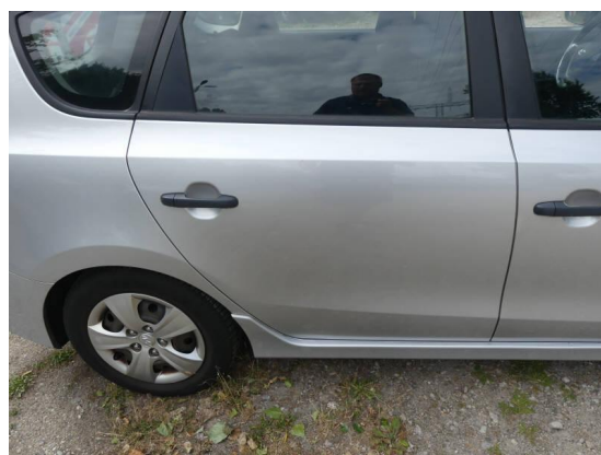
Bild 18: Karosserie / Tür hinten rechts leicht deformiert und zerkratzt
