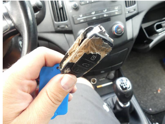
Bild 26: Technik / Schlüsselfernbedienung Gehäuse gebrochen und Schlüsselbart fehlt
