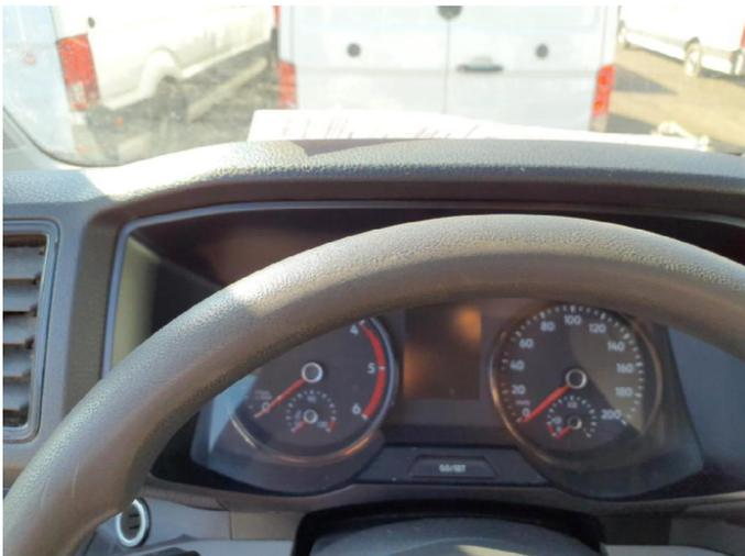
**Beschädigung 7:** Lenkanlage: Lenkrad - verschlissen - Smart Repair
