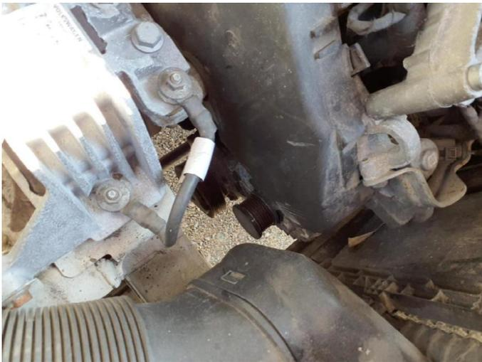
**Beschädigung 13:** Motor: Motor (Keilriemen fehlt) - Befund festlegen - Diagnose durchführen
