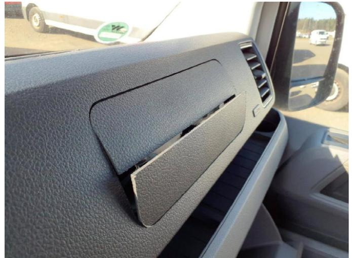
**Beschädigung 12:** Airbagssystem: Airbagsystem - Befund festlegen - Diagnose durchführen
