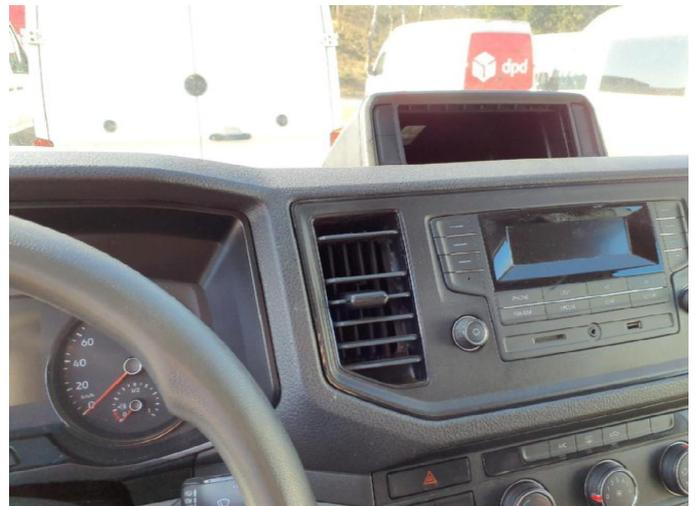
**Beschädigung 8:** Instrumententafel: Luftdüse Mitte - gebrochen / gerissen - erneuern
