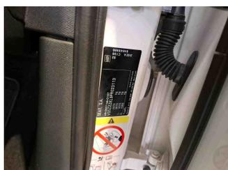
Fahrzeug - Typenschild/Fahrgestellnummer
