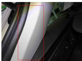
3 - Hintere Dachsäulenverkleidung rechts - Kratzer - Akzeptabel (Gebrauchsspur)
