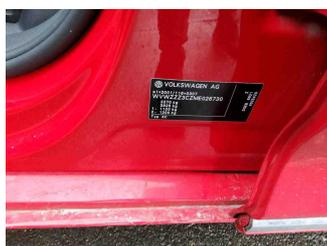
Fahrzeug - Typenschild/Fahrgestellnummer
