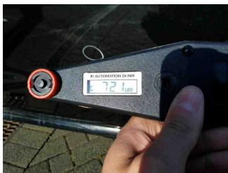
Lackstärke Seitenwand hinten links
