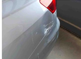
2 - Stoßfänger hinten - Deformiert - Ersetzen und lackieren
