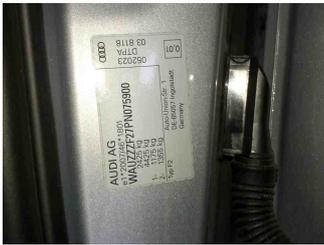
Fahrzeug - Typenschild/Fahrgestellnummer
