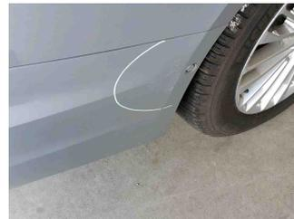
3 - Seitenwand hinten rechts - Delle(n) und Kratzer - Instandsetzen + lackieren
