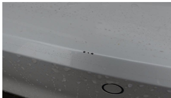
Bild 24: Stossfänger hinten Abplatzungen / Schaden schon bei Fahrzeugübernahme - Smart Repair
