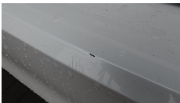
Bild 25: Stossfänger hinten Abplatzungen / Schaden schon bei Fahrzeugübernahme - Smart Repair
