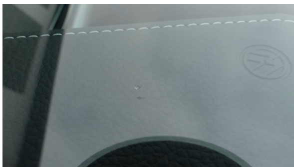
Bild 19: Frontscheibe Steinschlag / Schaden schon bei Fahrzeugübernahme - erneuern
