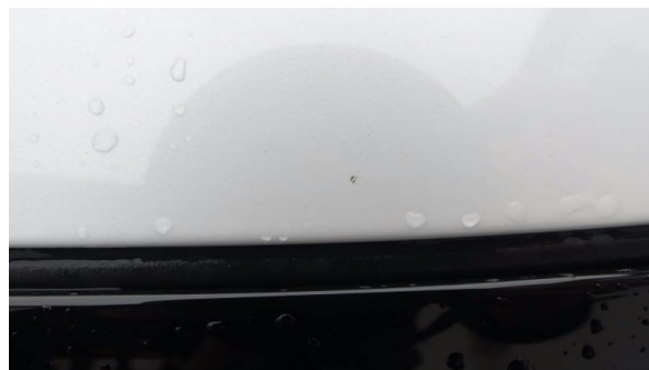
Bild 22: Motorhaube Abplatzungen / Schaden schon bei Fahrzeugübernahme - auslegen / polieren
