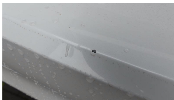
Bild 26: Stossfänger hinten Abplatzungen / Schaden schon bei Fahrzeugübernahme - Smart Repair
