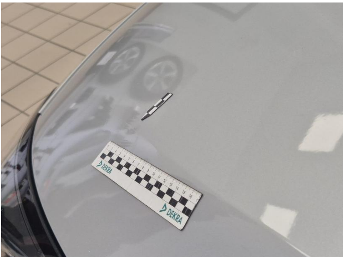
Fot. 34 Pokrywa komory silnika - Wgniecenie/odkształcenie 1
