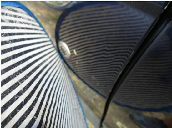
Bild 3: Karosserie / Tür vorne links leicht deformiert und zerkratzt
