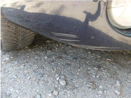
Bild 49: Karosserie / Stoßfänger vorn zerkratzt
