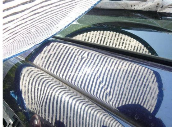
Bild 20: Karosserie / Heckklappe Dellen und zerkratzt
