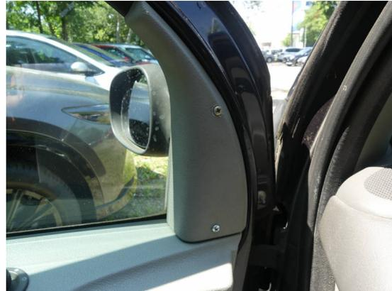
Bild 44: Innenraum / Verkleidung an Tür vorne links mit Schrauben befestigt
