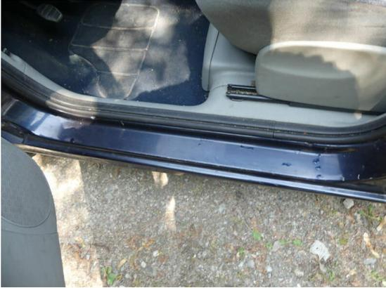
Bild 55: Karosserie / Einstieg vorne links zerkratzt
