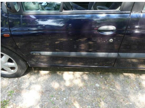
Bild 5: Karosserie / Tür vorne links leicht deformiert und zerkratzt
