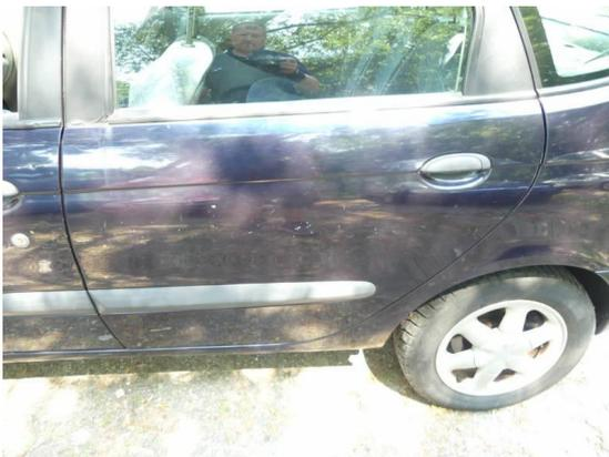
Bild 9: Karosserie / Tür hinten links deformiert und zerkratzt
