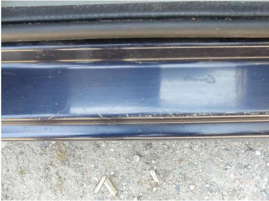
Bild 31: Karosserie / Einstieg vorne rechts zerkratzt
