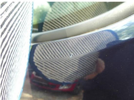
Bild 11: Karosserie / Seitenteil links Dellen und zerkratzt
