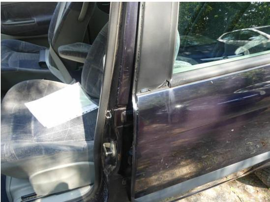
Bild 57: Karosserie / B-Säule links zerkratzt
