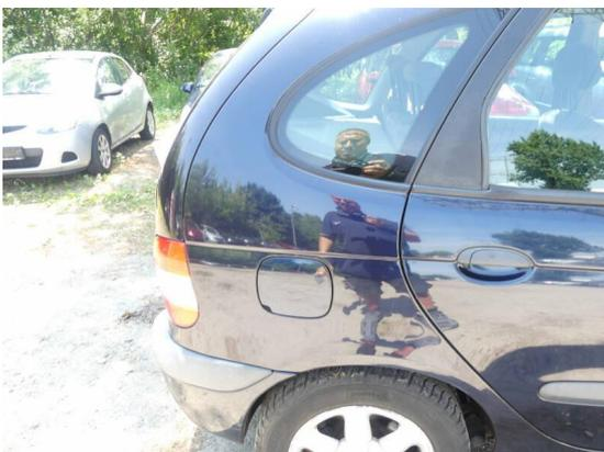
Bild 23: Karosserie / Seitenteil rechts leicht deformiert und zerkratzt
