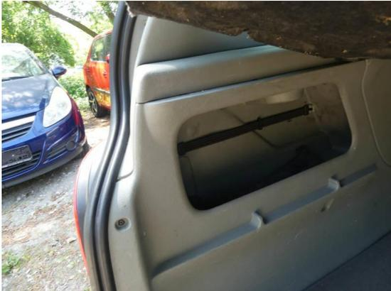
Bild 43: Innenraum / Klappe im Kofferraum links abgebrochen
