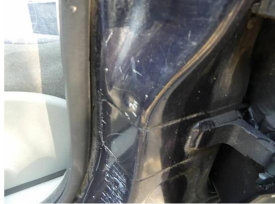
Bild 56: Karosserie / B-Säule links zerkratzt
