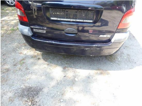
Bild 19: Karosserie / Stoßfänger hinten zerkratzt und stark gestaucht
