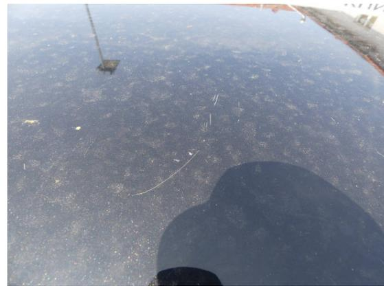
Bild 10: Karosserie / Dach zerkratzt
