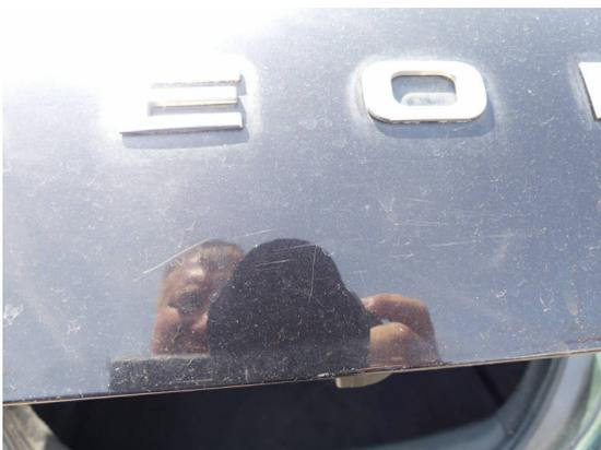
Bild 17: Karosserie / Heckklappe zerkratzt
