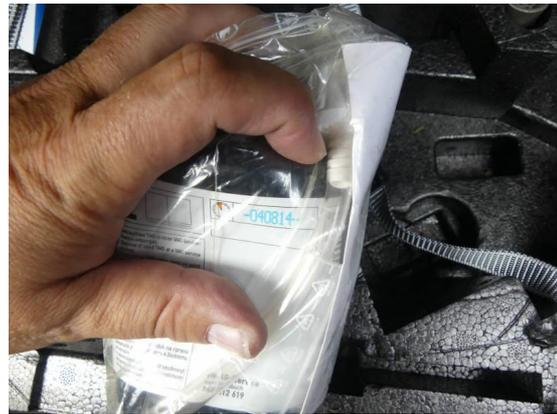
Bild 22: Reifen - Felge / Reifendichtmittel abgelaufen
