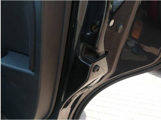
Bild 19: Technik / Türschloss hinten rechts entriegelt nicht über ZV
