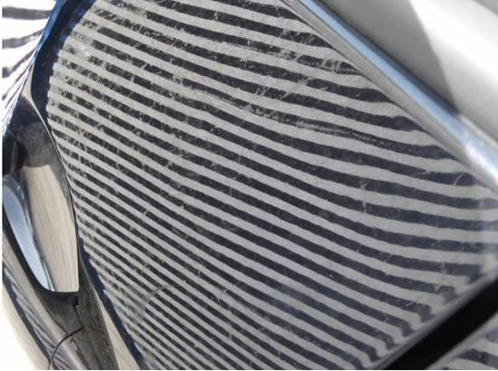
Bild 7: Karosserie / Tür vorne links Dellen und Kratzer
