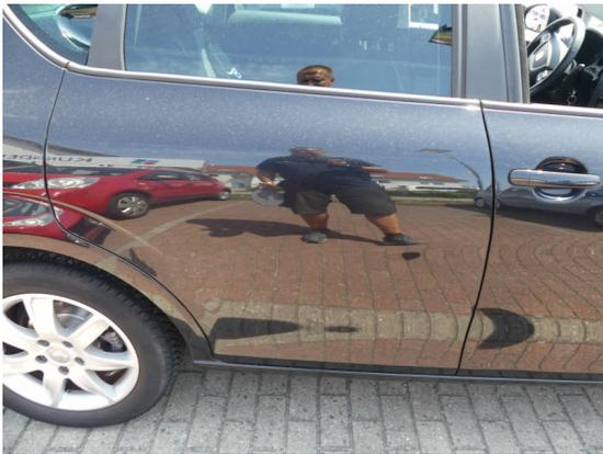
Bild 21: Karosserie / Tür hinten rechts Delle mit Kratzer
