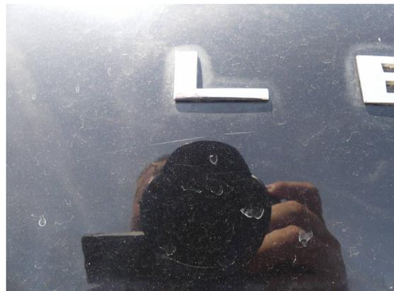
Bild 16: Karosserie / Heckklappe zerkratzt
