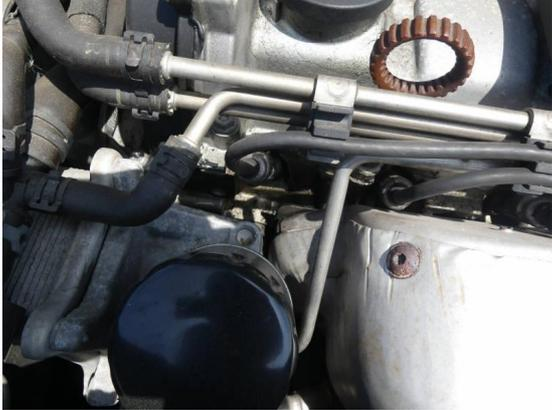
Bild 1: Technik / Motor verölt
