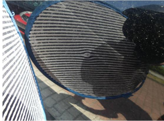
Bild 20: Karosserie / Tür hinten rechts Delle mit Kratzer
