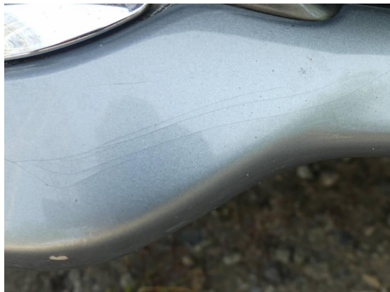
Bild 1: Karosserie / Stoßfänger vorn zerkratzt und gestaut
