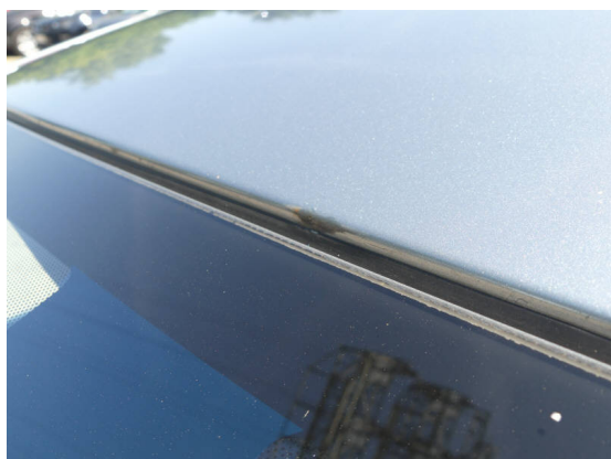
Bild 3: Karosserie / Dachkante vorn Steinschlag mit Korrosionsansatz
