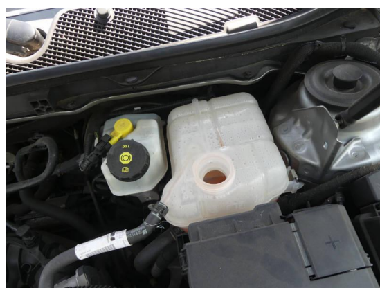
Bild 16: Technik / Kühlwasserbehälter Deckel fehlt
