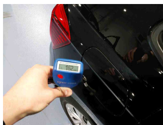
Lackstärke Seitenwand hinten rechts
