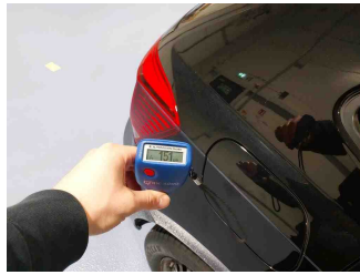
Lackstärke Seitenwand hinten rechts
