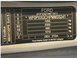
Fahrzeug - Typenschild/Fahrgestellnummer
