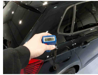
Lackstärke Seitenwand hinten rechts
