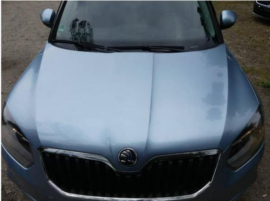
Bild 31: Karosserie / Motorhaube Kratzer + Steinschlag
