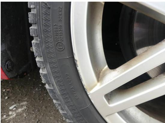
Bild 45: Reifen - Felge / Alufelgen Kratzer
