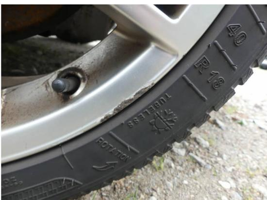
Bild 47: Reifen - Felge / Alufelgen Kratzer
