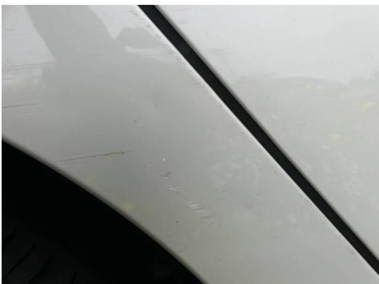
Bild 41: Karosserie / Fondseite rechts Kratzer und Dellen
