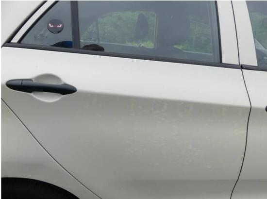
Bild 37: Karosserie / Tür hinten rechts Kratzer und Delle
