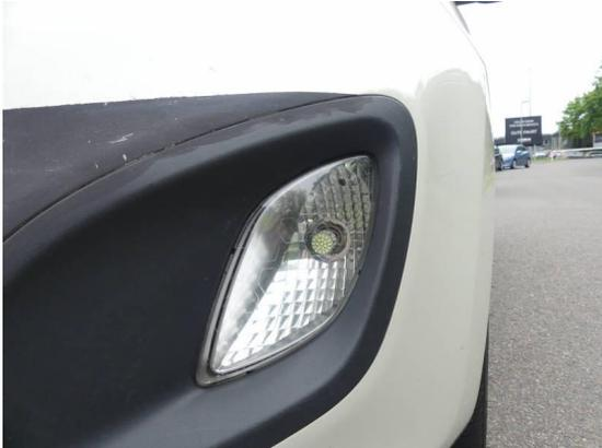
Bild 49: Technik / Leuchtmittel Leds verbaut-nicht zulässig
