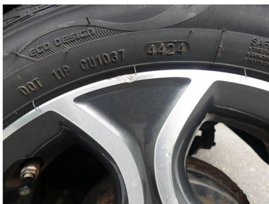
Bild 60: Reifen - Felge / 2x Felgen Kratzer
