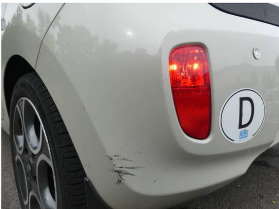
Bild 45: Karosserie / Stoßfänger hinten Kratzer
