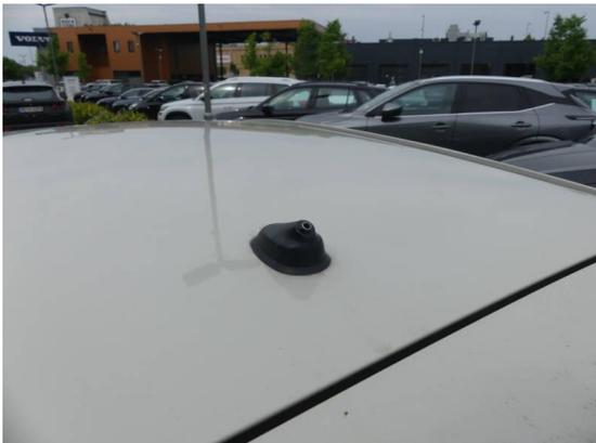
Bild 3: Technik / Antenne fehlt
