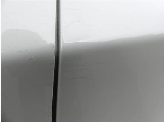
Bild 13: Karosserie / Tür hinten links Kratzer
