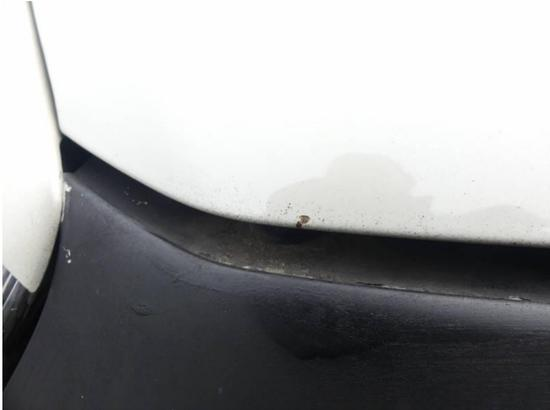
Bild 19: Karosserie / Motorhaube Steinschlag
