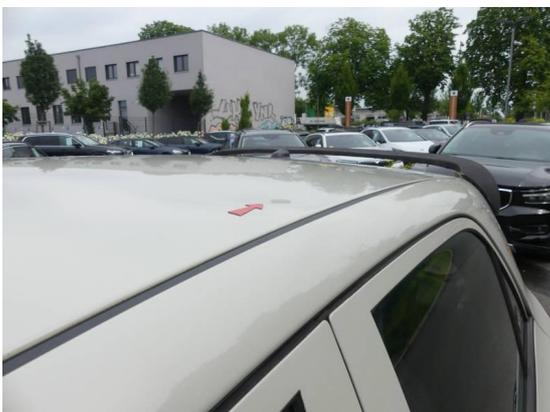
Bild 29: Karosserie / Dach Dellen
