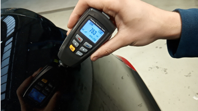
1. Seitenwand - Hinten - Links Nachlackiert -
