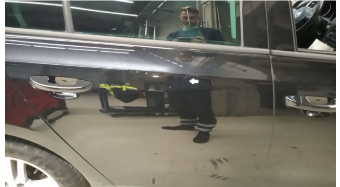
14. Tür Hinten - Rechts 1 Delle -
