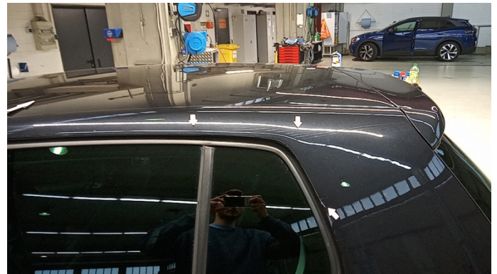
8. Dachrahmen - Links Kratzer -
