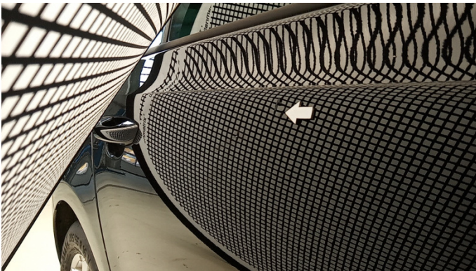
14. Tür Hinten - Rechts 1 Delle -
