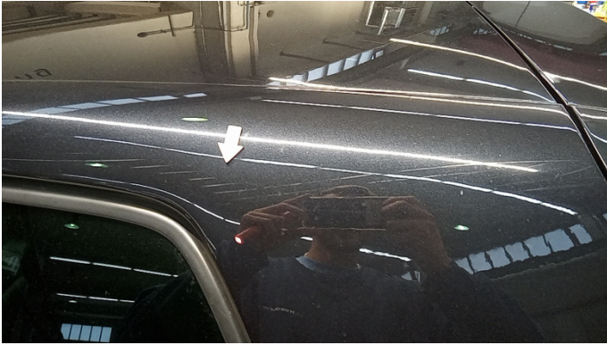
8. Dachrahmen - Links Kratzer -
