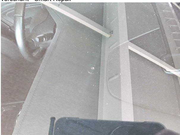
Beschädigung #7: Verglasung: Frontscheibe - gebrochen / gerissen - erneuern
