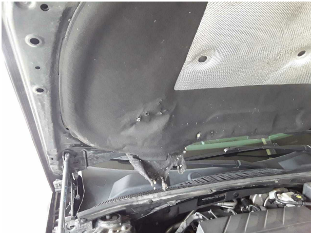
Beschädigung #2: Motorhaube: Dämmmatte - Marderschaden - erneuern
