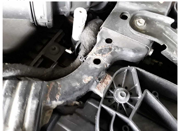
Beschädigung #3: Sonstiges: Fahrzeug - Korrosion - kein Abzug
