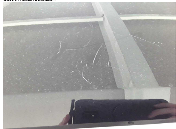
Beschädigung #10: Fahrzeugdach: Dach - Kratzer - auslege... polieren
