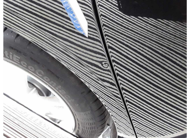
Beschädigung #9: Seitenwand rechts: Seitenwand - Delle(n) - sanft instandsetzen
