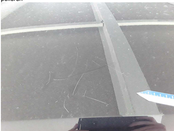
Beschädigung #10: Fahrzeugdach: Dach - Kratzer - auslegen / polieren
