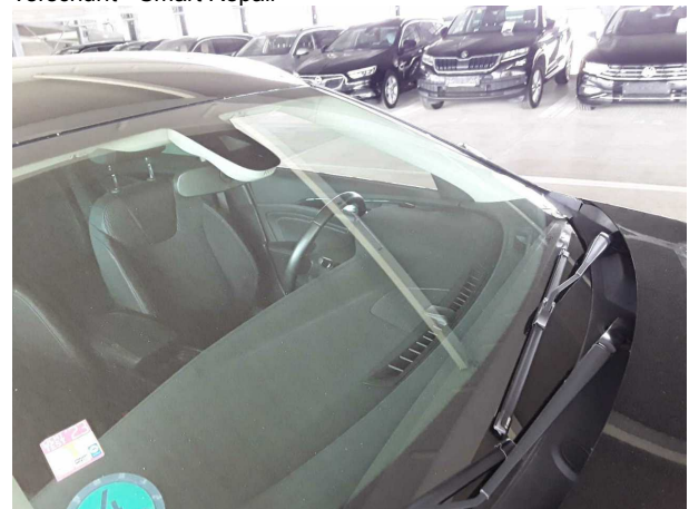
Beschädigung #7: Verglasung: Frontscheibe - gebrochen / gerissen - erneuern
