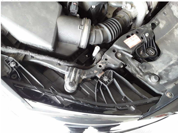
Beschädigung #3: Sonstiges: Fahrzeug - Korrosion - kein Abzug
