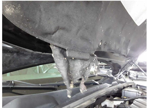
Beschädigung #2: Motorhaube: Dämmmatte - Marderschaden - erneuern
