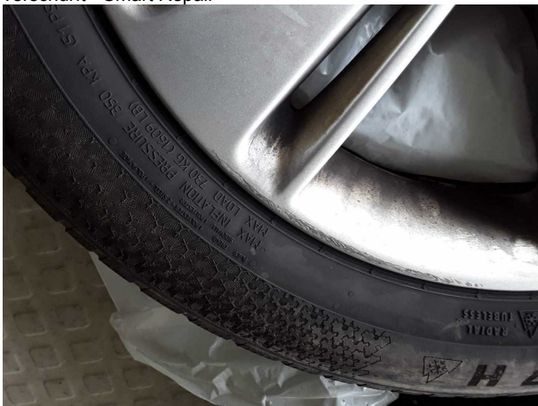
Beschädigung #6: 2.Radsatz: 1 Leichtmetallfelge - verkratzt / verschürft - Smart Repair
