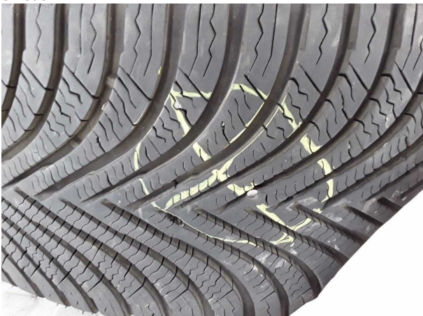
Beschädigung #3: 2.Radsatz: 1 Reifen (Luftverlust) - beschädigt - erneuern
