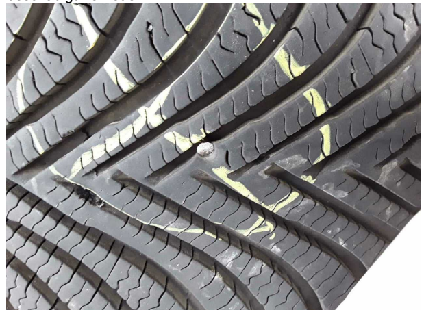
Beschädigung #3: 2.Radsatz: 1 Reifen (Luftverlust) - beschädigt - erneuern
