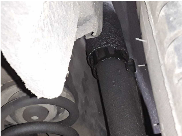
Beschädigung #1: Hinterachse: Stoßdämpfer rechts - beschädigt - erneuern
