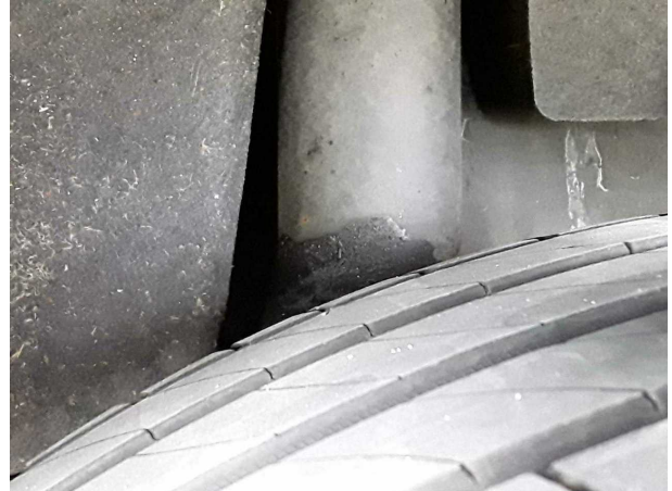
Beschädigung #1: Hinterachse: Stoßdämpfer rechts - beschädigt - erneuern
