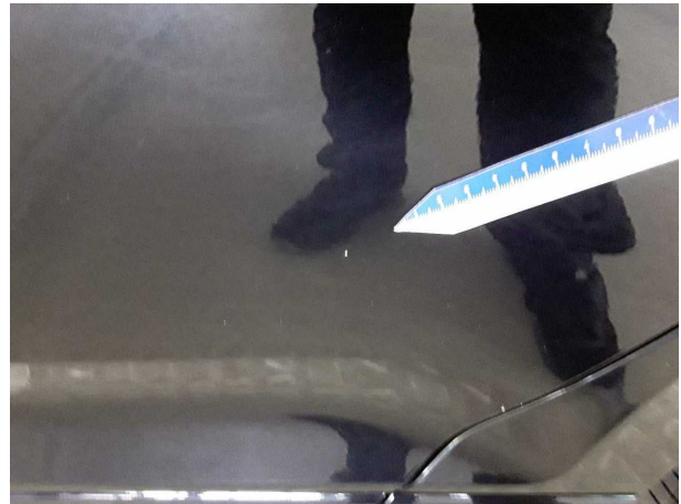
Beschädigung #6: Tür hinten links: Tür - Steinschlag - instandsetzen und lackieren
