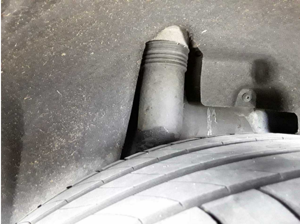
Beschädigung #1: Hinterachse: Stoßdämpfer rechts - beschädigt - erneuern
