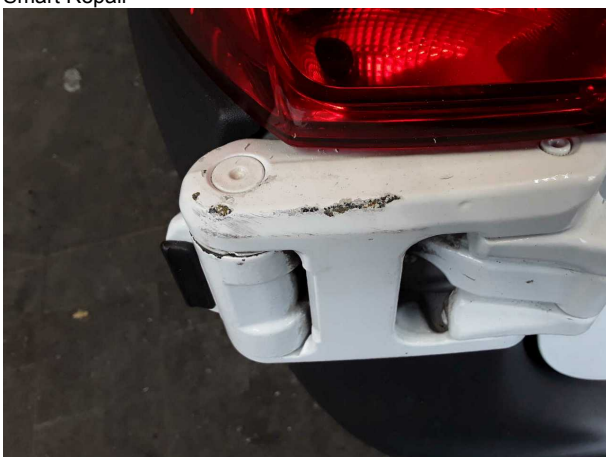
Beschädigung #9: Heckklappe/-tür: Scharnier unten - Kratzer - instandsetzen
