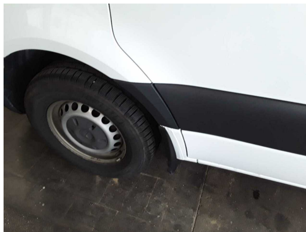
Beschädigung #13: Kotflügel links: Kotflügel links - Kratzer - Smart Repair
