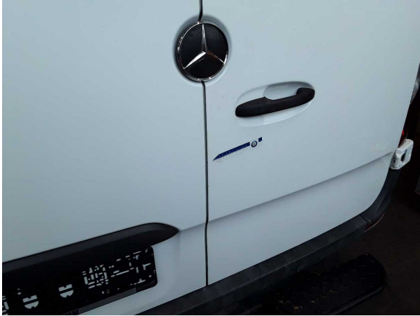
Beschädigung #8: Heckklappe/-tür: Hecktür rechts - Kratzer - Smart Repair
