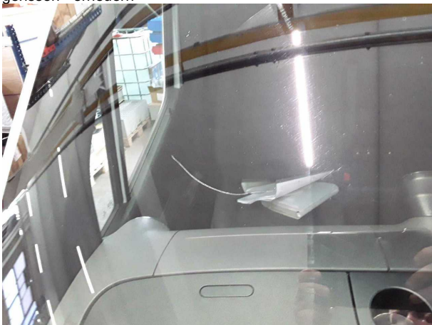
Beschädigung #4: Verglasung: Frontscheibe - gebrochen / gerissen - erneuern
