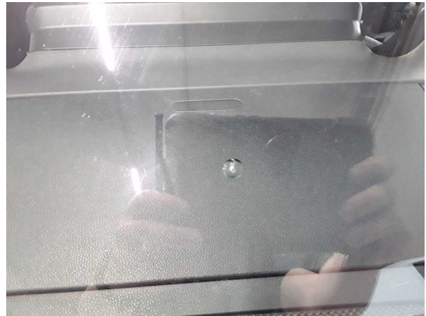
Beschädigung #4: Verglasung: Frontscheibe - gebrochen / gerissen - erneuern
