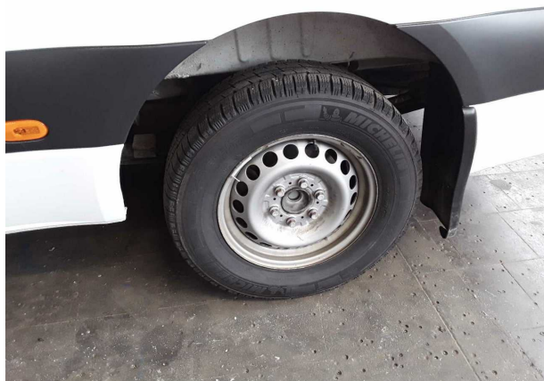
Beschädigung #12: Rad/Reifen: Radblende hinten links - fehlt - erneuern
