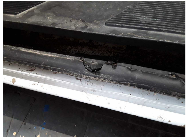
Beschädigung #1: Schiebetür rechts: Türdichtung - gebrochen / gerissen - erneuern
