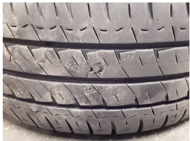
Beschädigung #3: 2.Radsatz: 1 Reifen - beschädigt - erneuern
