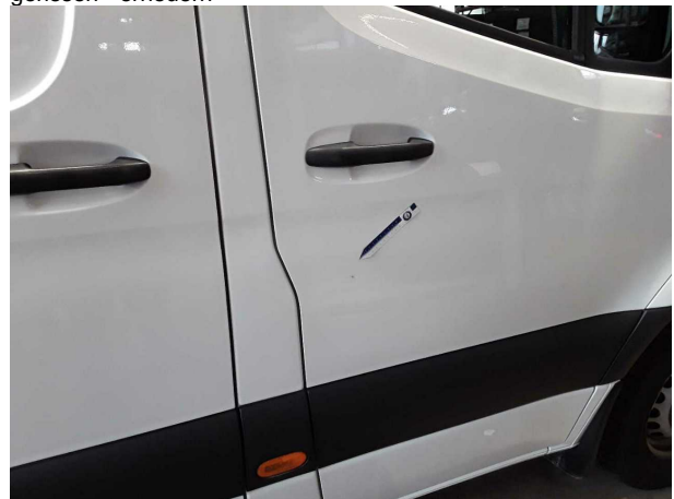
Beschädigung #5: Tür vorn rechts: Tür - Kratzer - instandsetzen und lackieren
