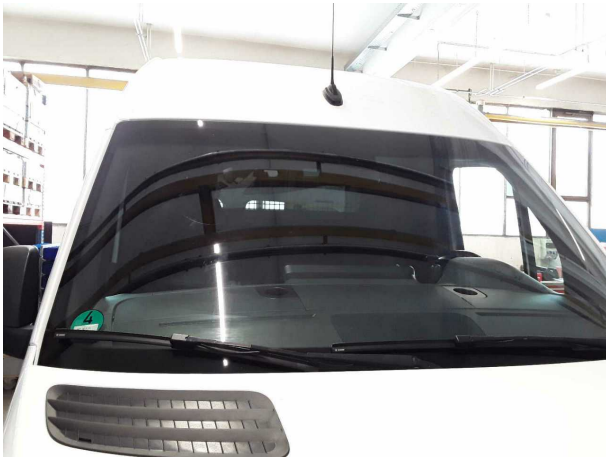
Beschädigung #4: Verglasung: Frontscheibe - gebrochen / gerissen - erneuern
