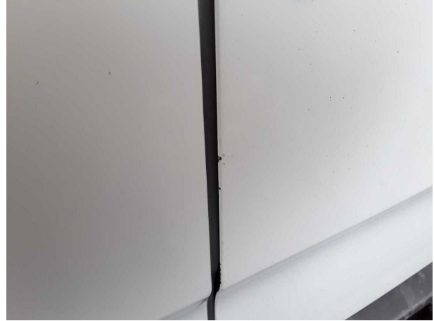
Beschädigung #8: Heckklappe/-tür: Hecktür rechts - Kratzer - Smart Repair
