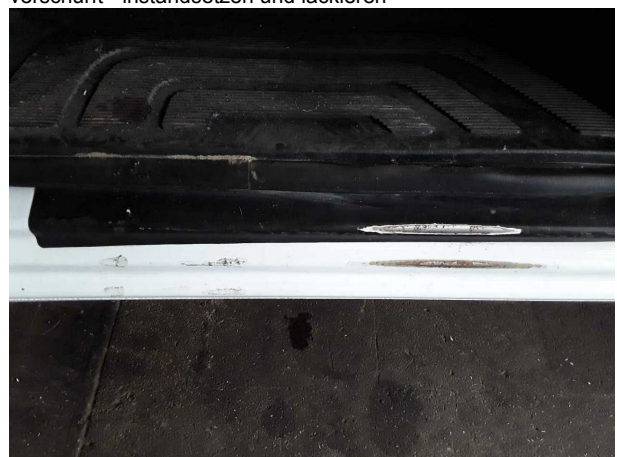
Beschädigung #11: Schweller links: Schweller - verkratzt / verschürft - instandsetzen und lackieren
