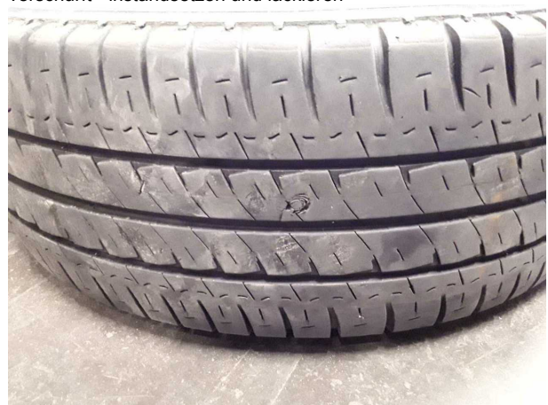
Beschädigung #3: 2.Radsatz: 1 Reifen - beschädigt - erneuern
