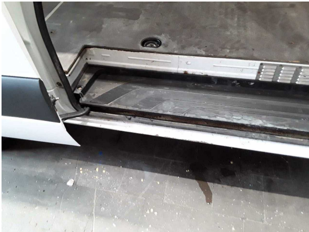
Beschädigung #1: Schiebetür rechts: Türdichtung - gebrochen / gerissen - erneuern
