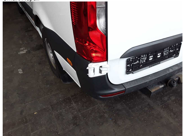
Beschädigung #9: Heckklappe/-tür: Scharnier unten - Kratze... instandsetzen
