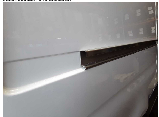
Beschädigung #7: Schiebetür rechts: Führungsschiene (Anschlag) - fehlt - erneuern
