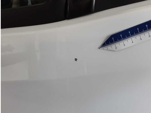
Beschädigung #10: Tür vorn links: Tür - Kratzer - instandsetzen und lackieren
