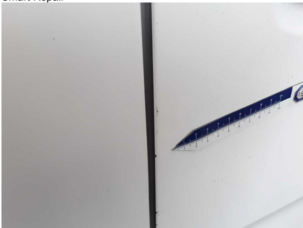
Beschädigung #8: Heckklappe/-tür: Hecktür rechts - Kratzer - Smart Repair
