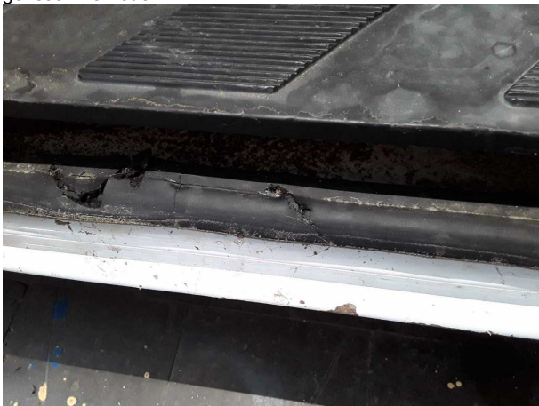
Beschädigung #1: Schiebetür rechts: Türdichtung - gebrochen / gerissen - erneuern
