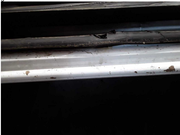
Beschädigung #2: Schweller rechts: Schweller - verkratzt / verschürft - instandsetzen und lackieren
