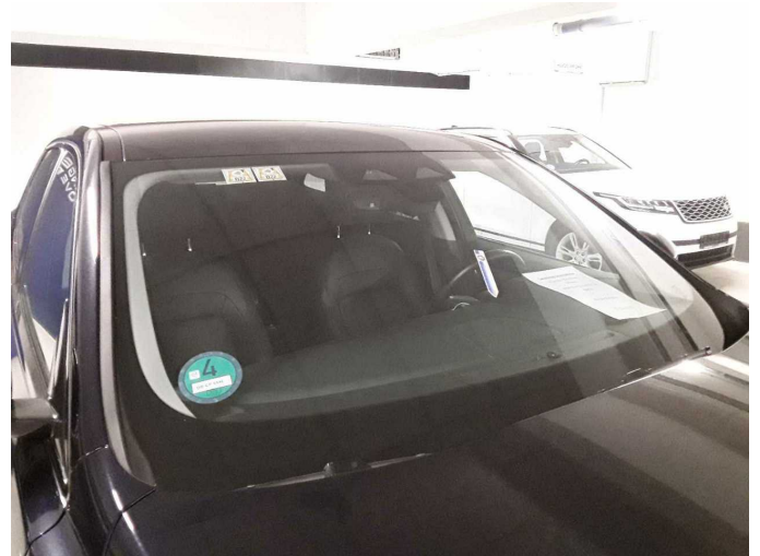
Beschädigung 2: Verglasung: Frontscheibe (mit Rissbildung) - Steinschlag - erneuern
