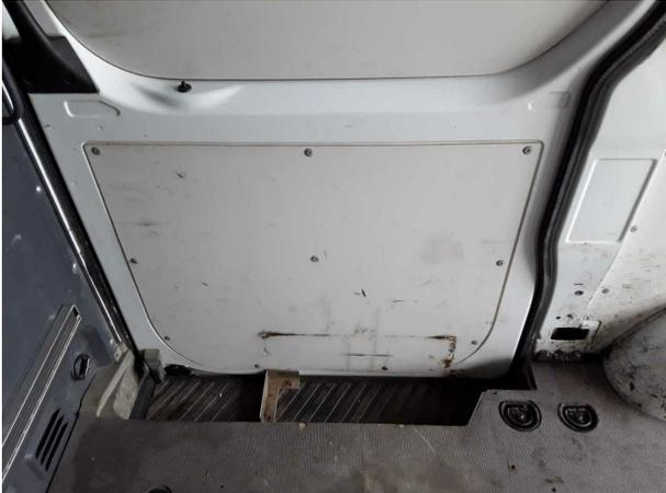
**Beschädigung #1:** Schiebetür rechts: Verkleidung Standard unten - gebrochen / gerissen - erneuern
