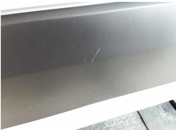
**Beschädigung #14:** Schiebetür rechts: Schutzleiste - verkratzt / verschürft - erneuern
