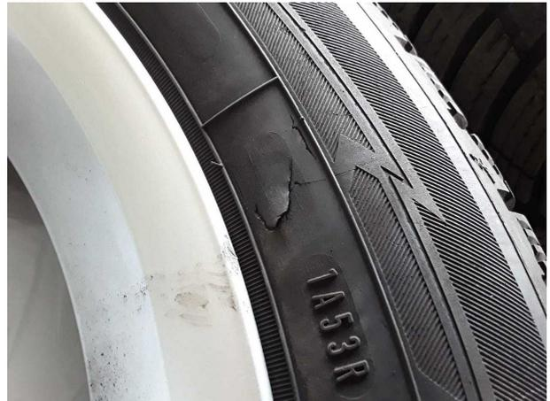
**Beschädigung #4:** 2.Radsatz: 1 Reifen - beschädigt - erneuern
