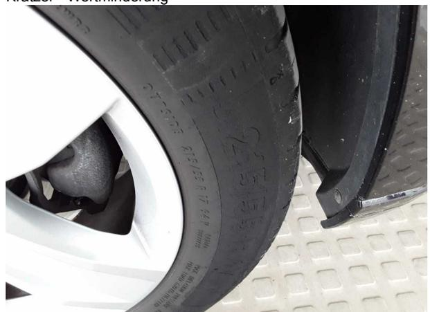
**Beschädigung #3:** Rad/Reifen: Reifen vorn rechts - beschädigt - erneuern
