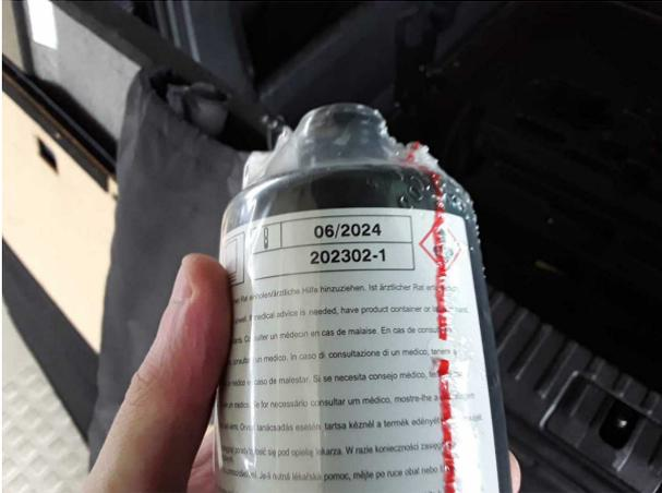
**Beschädigung #1:** Ausrüstung: Tirefit Füllmittel - abgelaufen - erneuern
