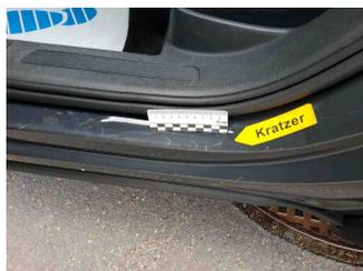
6 - Einstiegsschweller vorne links - Delle(n) und Kratzer - Instandsetzen + lackieren
