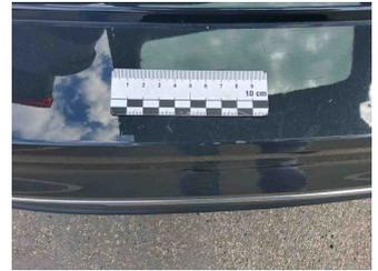
2 - Seitenwand hinten links - Delle(n) und Kratzer - Instandsetzen + lackieren
