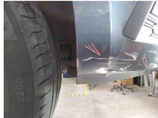
2 - Einstiegsschweller vorne rechts - Delle(n) und Kratzer - Instandsetzen + lackieren
