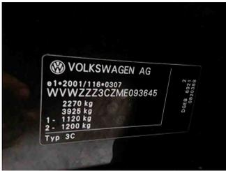
Fahrzeug - Typenschild/Fahrgestellnummer
