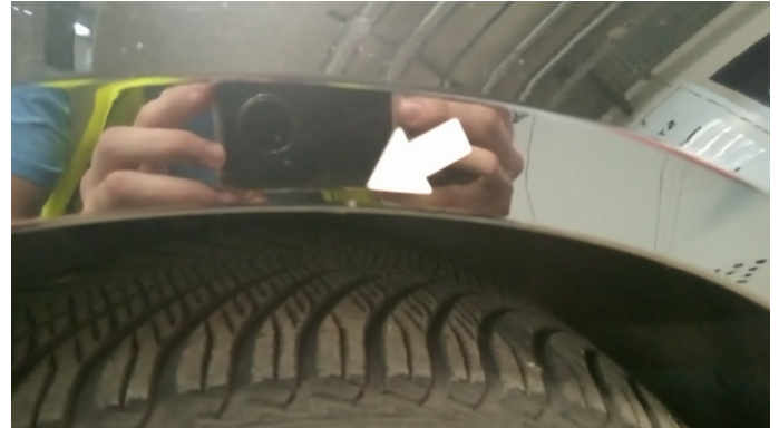
3. Kotflügel Vorne - Rechts Kratzer -
