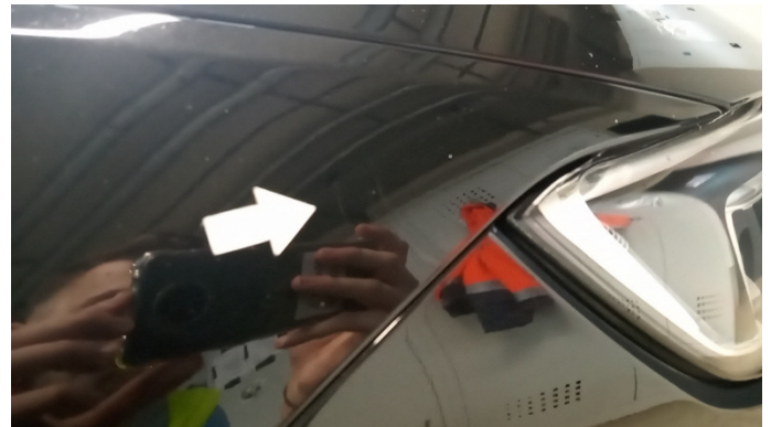
3. Kotflügel Vorne - Rechts Kratzer -
