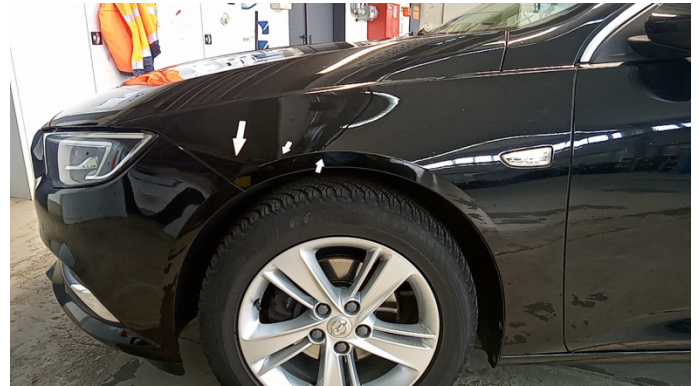
6. Kotflügel Vorne - Links Kratzer -
