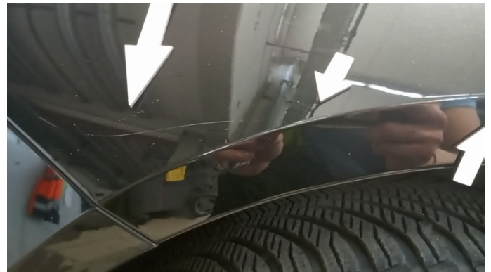
6. Kotflügel Vorne - Links Kratzer -
