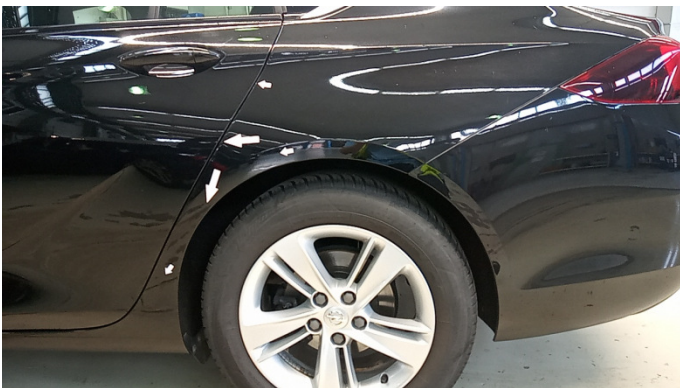
9. Seitenwand - Hinten - Links Kratzer -
