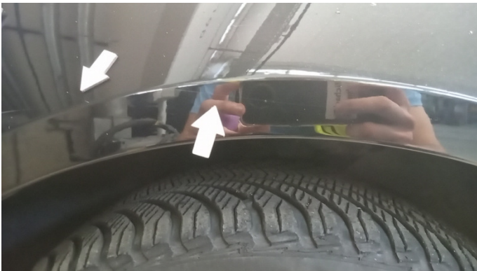
6. Kotflügel Vorne - Links Kratzer -
