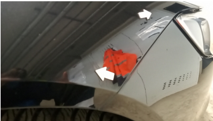
3. Kotflügel Vorne - Rechts Kratzer -
