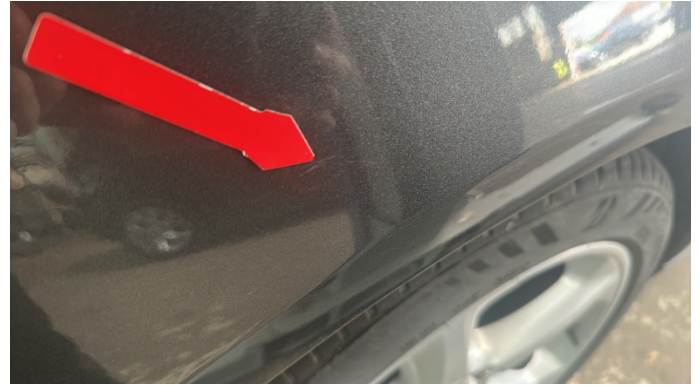
4. Seitenwand - Hinten - Rechts Kratzer -
