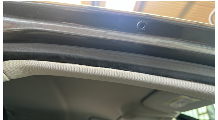
9. Dachhimmel Nicht In Ordnung -
